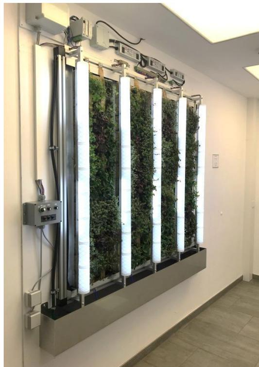
Abbildung 5: Demonstrator des autonomen Living-Wall-Systems mit geöffneter Blende
